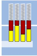
Wenn man den Schlüssel hineinschiebt, sind die Höhen der vier Bartelemente zusammen mit den vier Stiften gleich, so dass der Zylinder gedreht werden kann:
