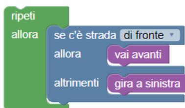
L'idea base consiste nel far procedere il robot lungo il bordo (prima inferiore e poi quello a destra) e farlo girare ad ogni angolo verso sinistra. In questo modo arriverà in modo quasi “automatico” a destinazione.
