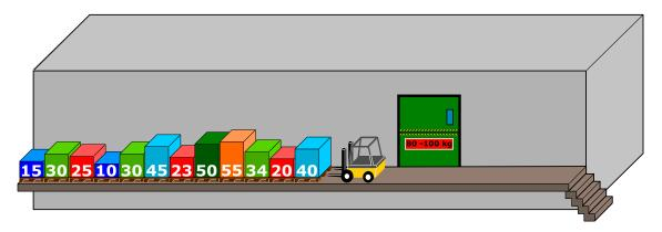
L'élévateur de palettes déplace généralement d'abord la palette qui se trouve le plus près du montecharge. Au cas où le poids total dépasse les 100 kg lors du chargement de l'ascenseur avec la dernière palette, l'élévateur de palettes dépose cette dernière à l'autre bout de la plate-forme (à droite). Si le poids total ne dépasse pas les 100 kg, la palette restera dans le monte-charge.
